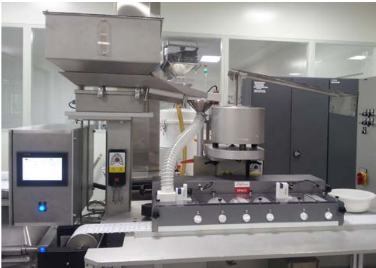
Distribution par Boîte à brosse sur machine Noack DPN916
